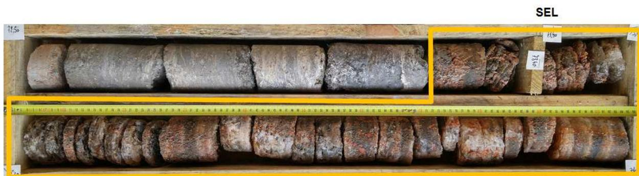
Illustration 4 : Apparition du sel dans le forage (caisse carotte 72.5m – 74.5 m)
