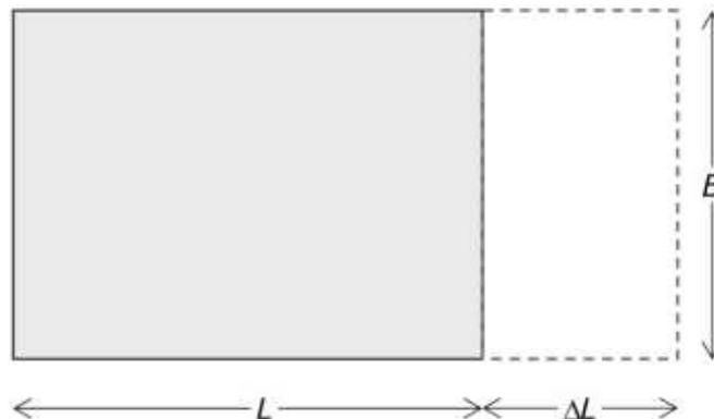
Figure 5.12 : exemple de l'augmentation de la longueur.
