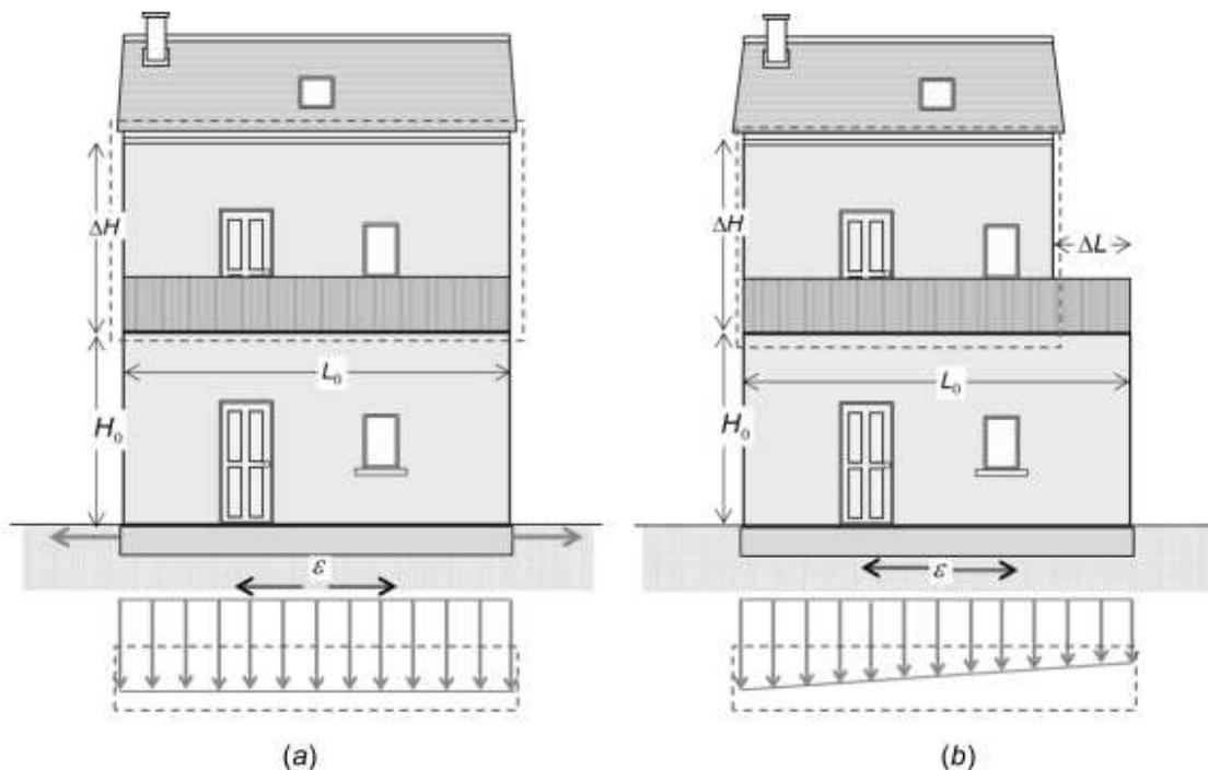
Figure 5.7 : exemple de la surélévation (a) entière et (b) partielle d'un niveau
