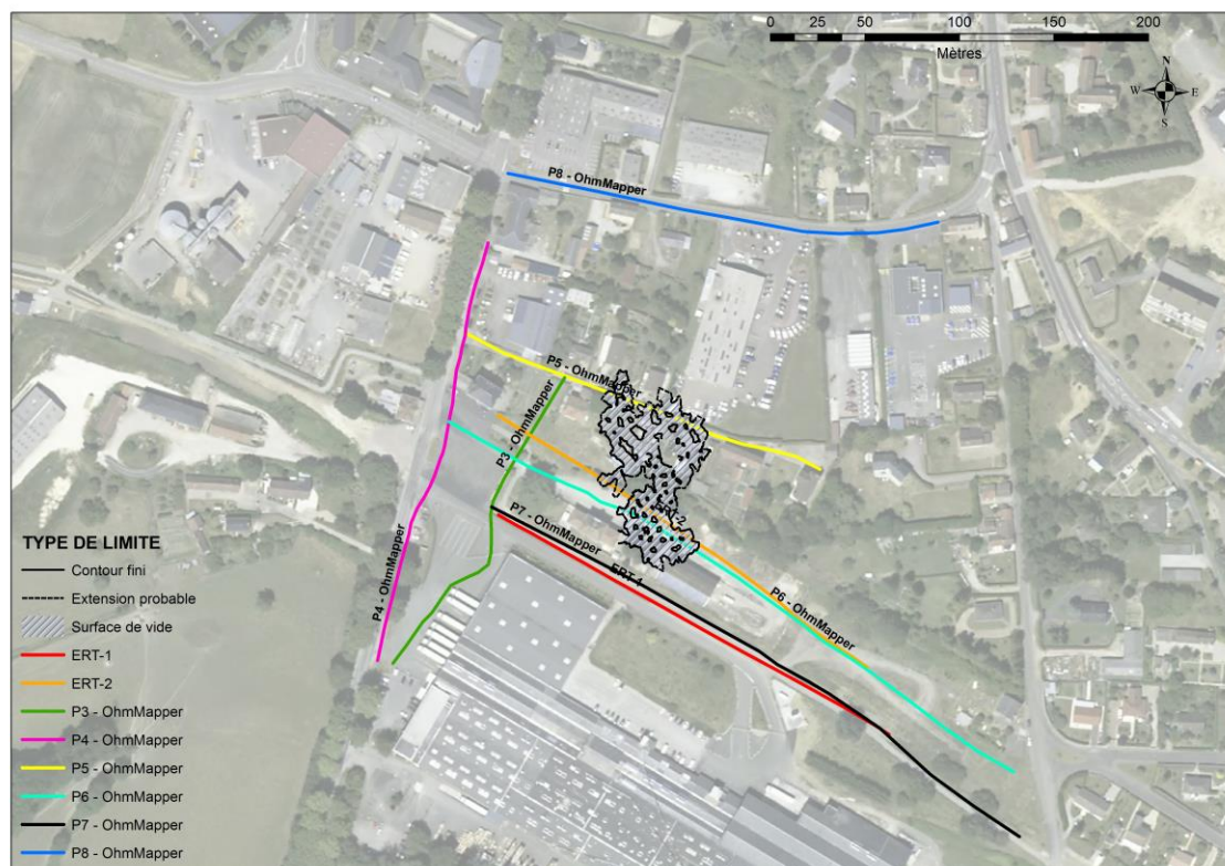
Illustration 18 : Situation des profils électriques effectués sur la carrière de Saint-Langis-lès-Mortagne
