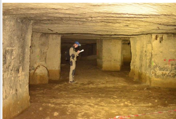
Illustration 5 : Exemple d'une géométrie caractéristique d'une carrière exploitée par chambres et piliers tournés (Loisail – Orne)
