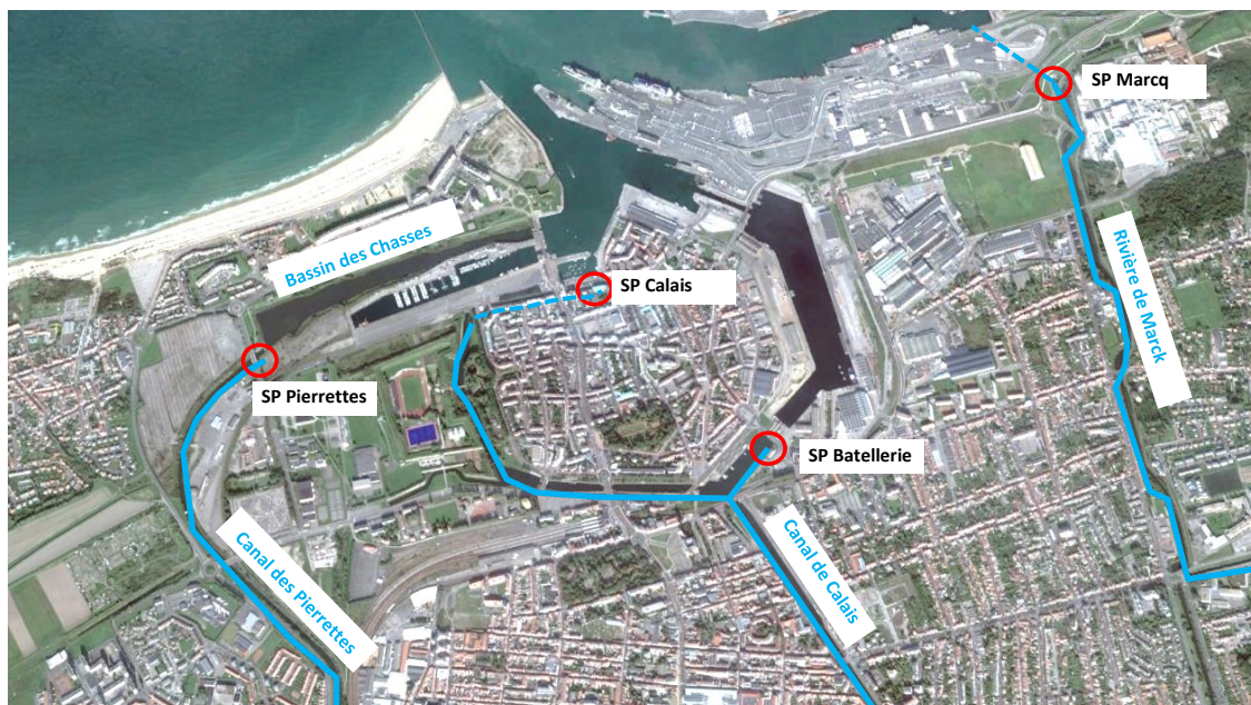
Figure 53 : Système hydraulique d'évacuation du Calaisis.
