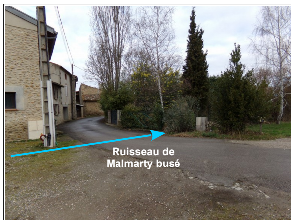
Figure 3.41: le ruisseau de Malmarty est busé en amont et sous la route de Fontanet. Cette dernière peut favoriser la diffusion des débordements dans le village.
