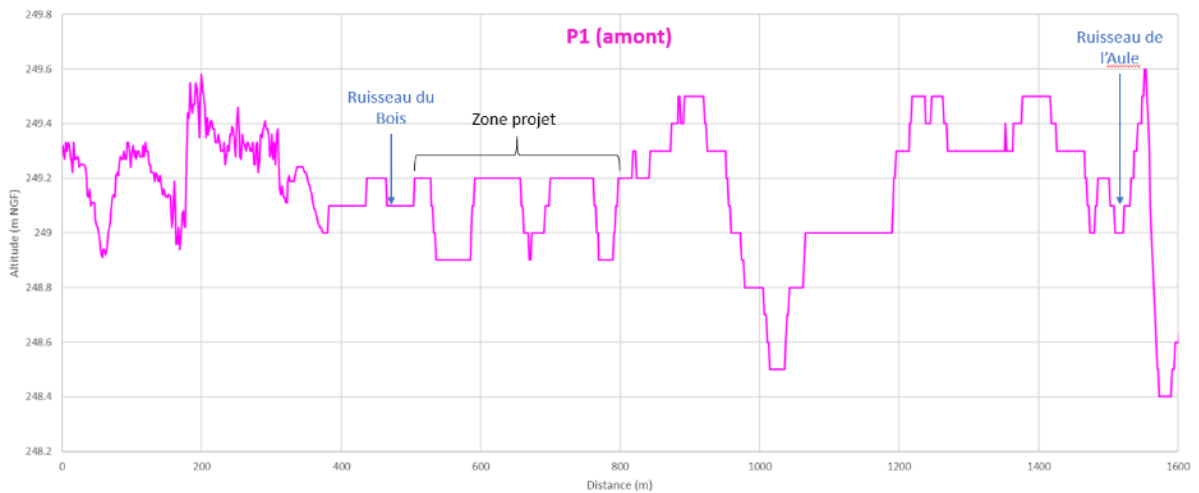
Figure 28. Profil travers P1 (amont)
