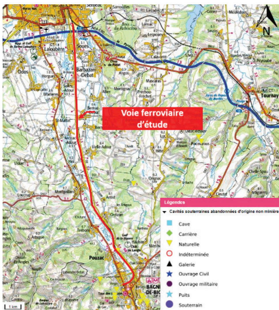
Figure 32. Cavités souterraines abandonnées à proximité de la voie ferrée (source : Géorisques)
