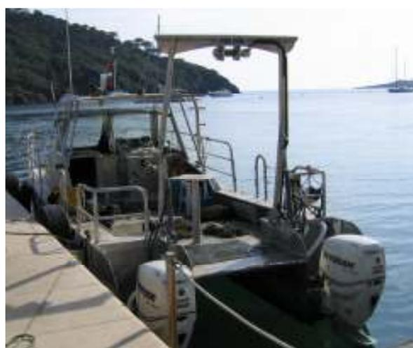
**Catamaran 8,50 m X 3.00 m** Construction aluminium « Strongall » **chantier META**. Tirant d'eau 0.50 m / 0.70 m Motorisation HB: **2 x 200 CV**. Navire **insubmersible**. **Navire de charge armé au commerce.**
