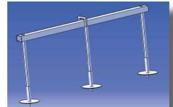
Modèle 4 : Vis à sable avec barre d'accouplement
