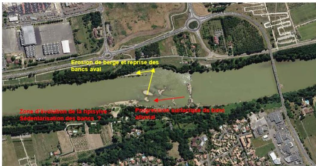
Fig. 5. Evolution de la berge en rive droite (source : HYDRATEC avril 2017)
