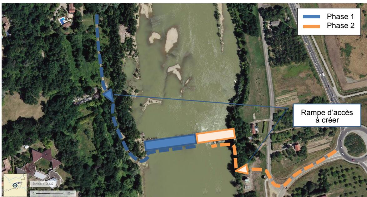
**Fig. 26. Schéma de principe des accès et des pistes chantier**
