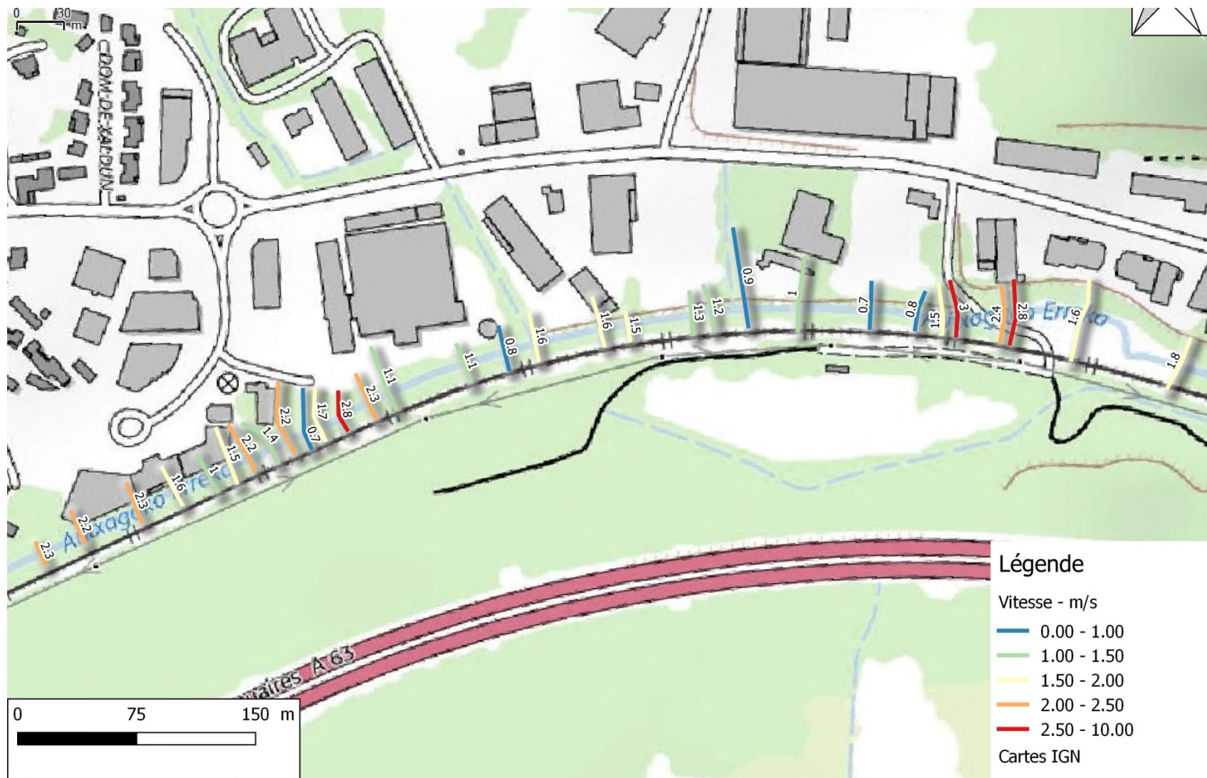
Fig. 6. Crue centennale sans clapet – vitesses maximales
