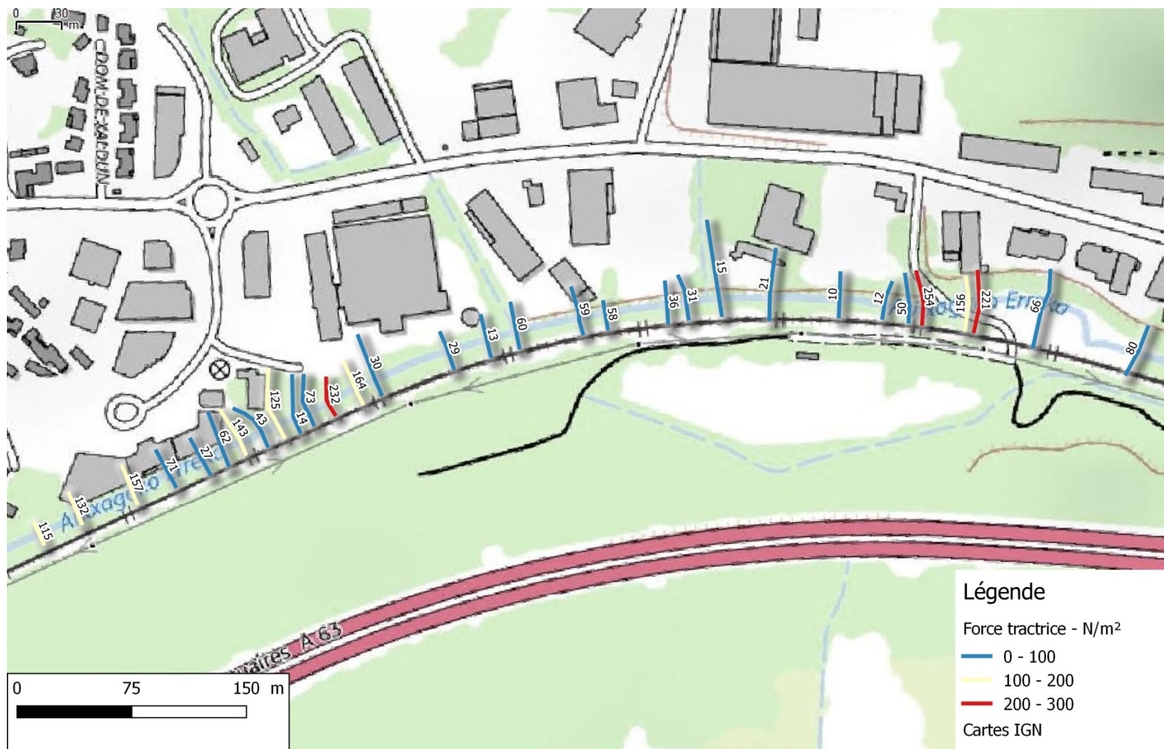
Fig. 5. Crue centennale sans clapet – forces tractrices
