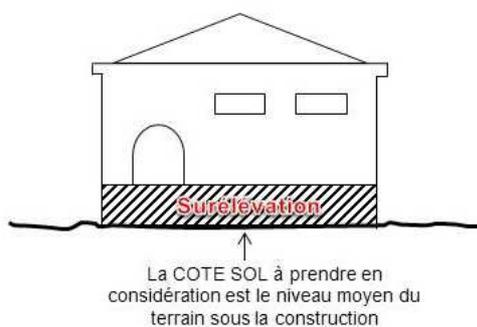
Cas d'un terrain en pente, sans travaux de terrassement autre que le décapage sous la construction
