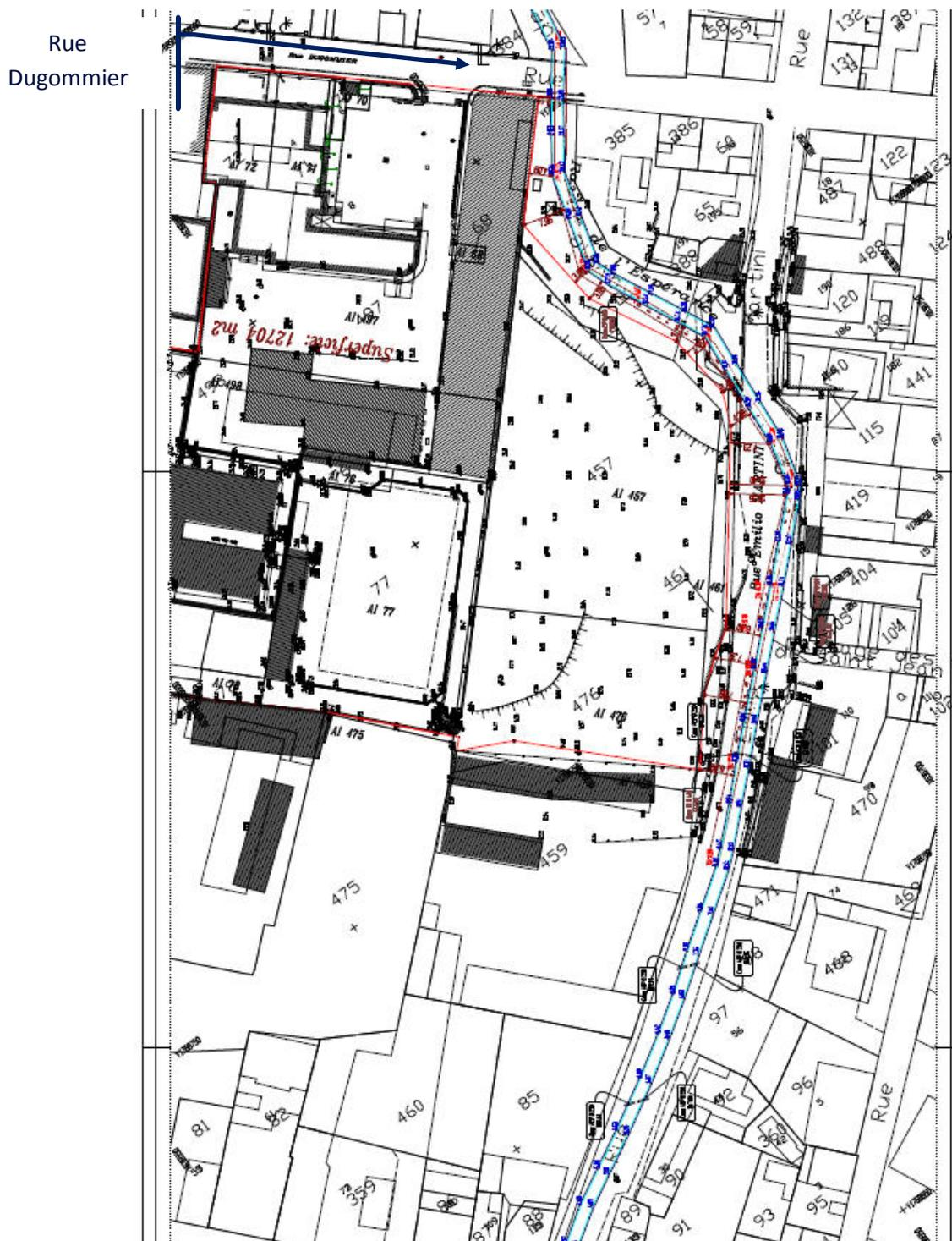
Figure 5 : Extrait du plan des reconnaissances du dalot enterré réalisées par HYGITECH en octobre 2017 (source [2]) et recalage topographie selon [3].
