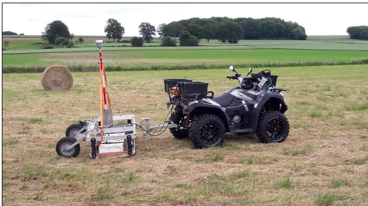
Figure 16 : Géoradar RIS MF HIMOD IDS (quad équipé d'une antenne STREAM X V16 200 MHz)
