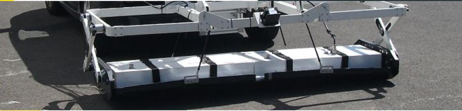
**LE GEORADAR STREAM X est un nouveau système basé sur les réseaux d'antennes compactes. Il est l'outil idéal pour la cartographie 3D du sous sol.**
