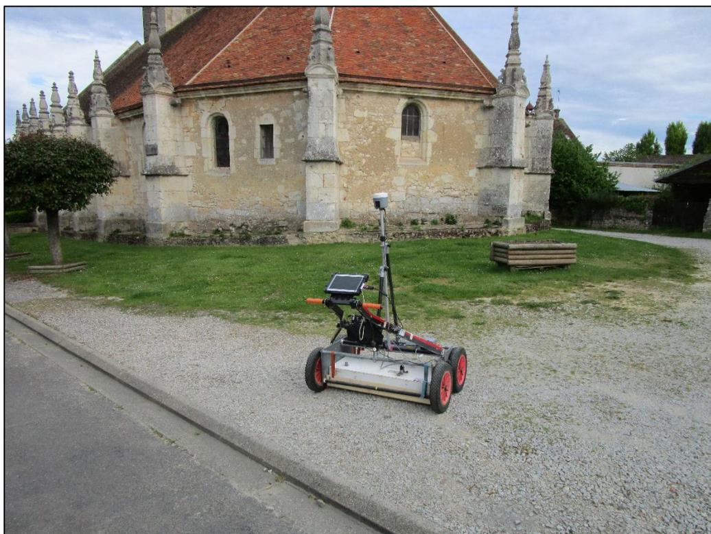
Figure 15 : Géoradar RIS MF HIMOD IDS (chariot manuel équipé d'une antenne STREAM X V8 200 MHz)
