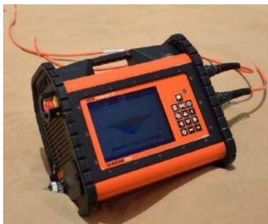
Figure 22 : le résistivimètre multi-électrodes LS-2
