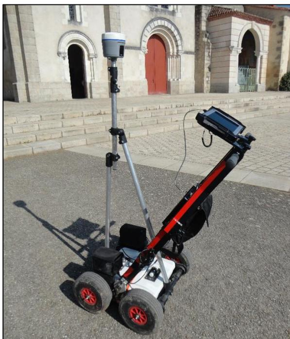
Figure 17 : Géoradar RIS MF HIMOD IDS (chariot manuel équipé d'une antenne duale 200-600 MHz)
