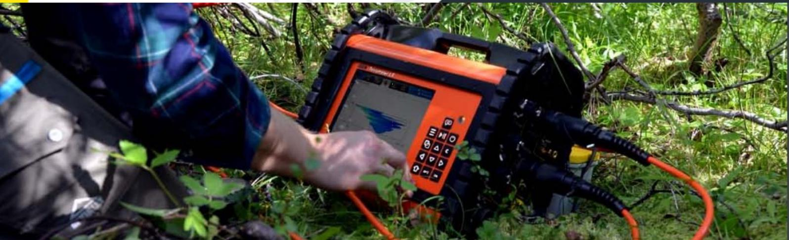
Le **TERRAMETER LS 2** est un résistivimètre multi-électrodes puissant équipé d'un multiplexeur intégré. C'est l'instrument idéal pour toutes vos mesures 1D, 2D, 3D et 4D de résistivité, de polarisation provoquée (IP) et de potentiel spontané (SP).
