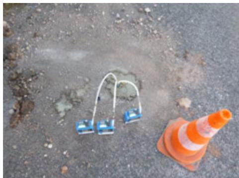
**Photo 3 : photographie du prélèvement de gaz du sol dans l'ouvrage PzA2**
