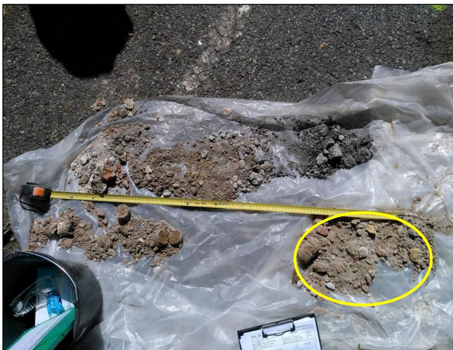
Photo 18 : Lithologie du sondage S2E-PZ2 de 2,4 à 7 m de profondeur avec la présence de morceaux de tuiles rouges (en jaune)
