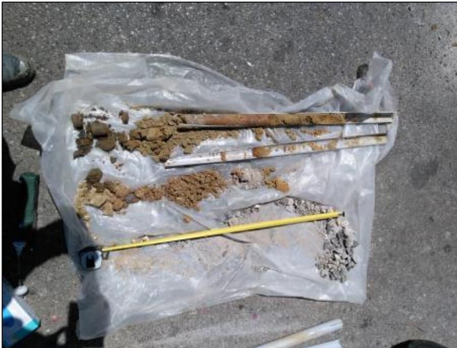
Photo 10 : Lithologie du sondage S2E-2 de 0 à 5 m de profondeur
