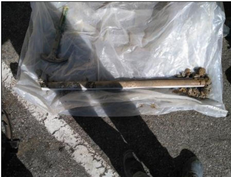
Photo 17 : Lithologie du sondage S2E-PZ2 de 0 à 2,4 m de profondeur
