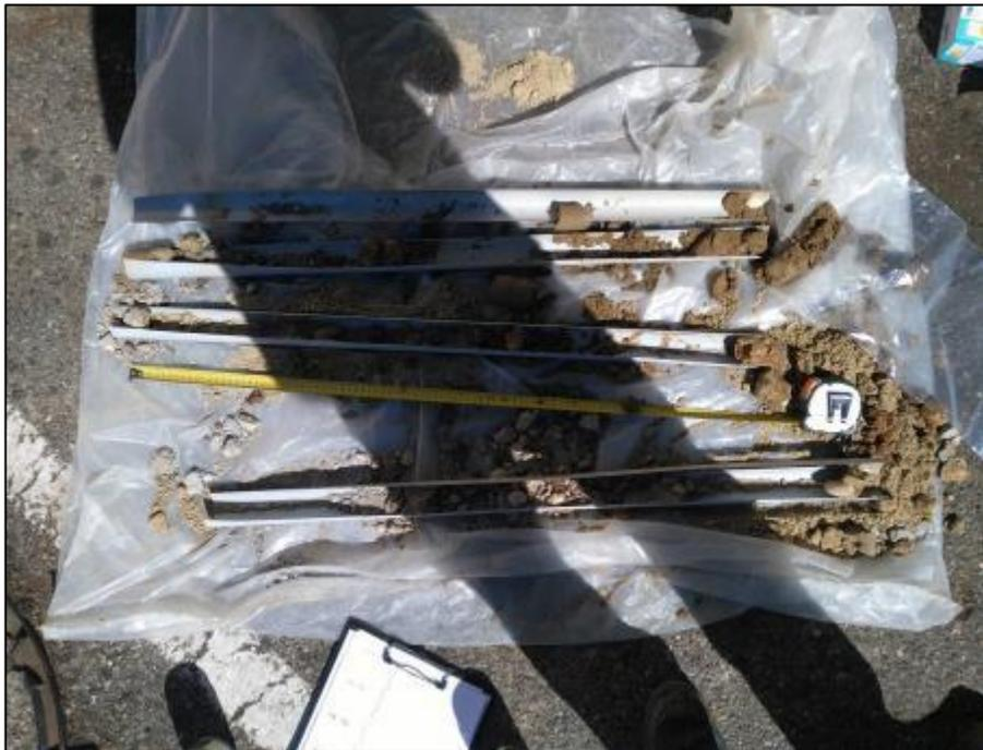
Photo 6 : Lithologie du sondage S2E-1 de 0 à 7 m de profondeur
