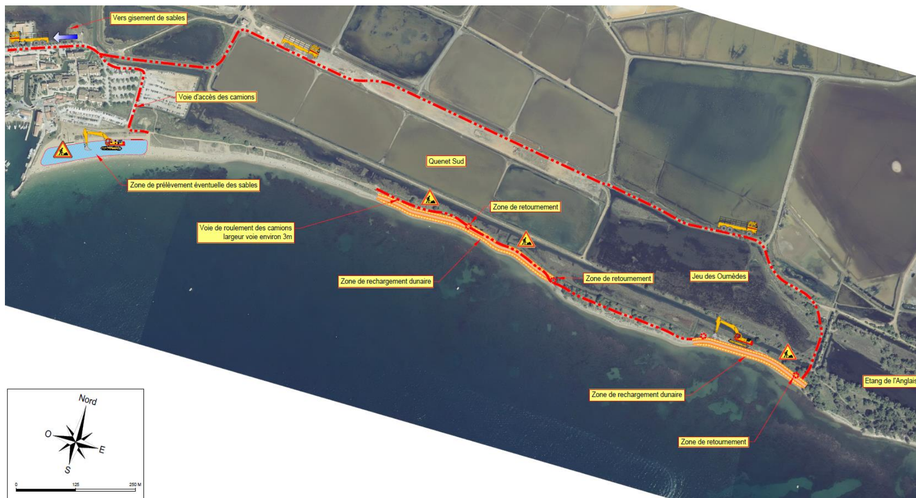
Fig. 28. Emprise des travaux de rechargement dunaire
