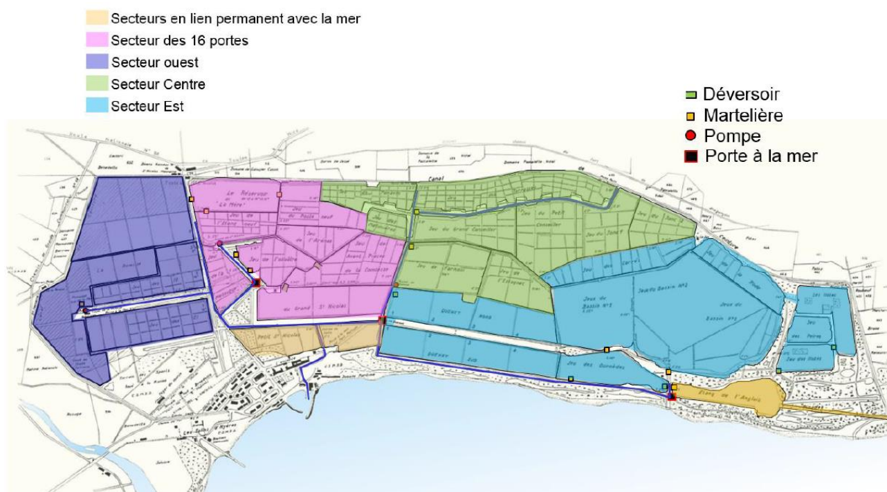
Fig. 67. Carte du fonctionnement hydraulique des Vieux Salins (source : Conservatoire du littoral)
