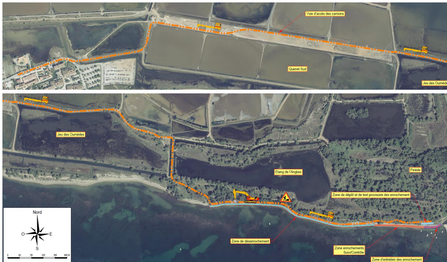
Fig. 30. Emprise des travaux de suppression et entretien des enrochements
