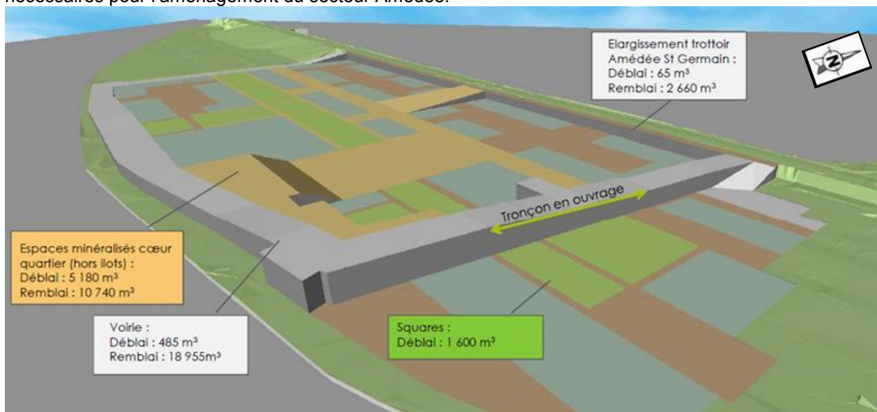
Figure 13 : Vue 3D des déblais/remblais projetés (source : EGIS)
