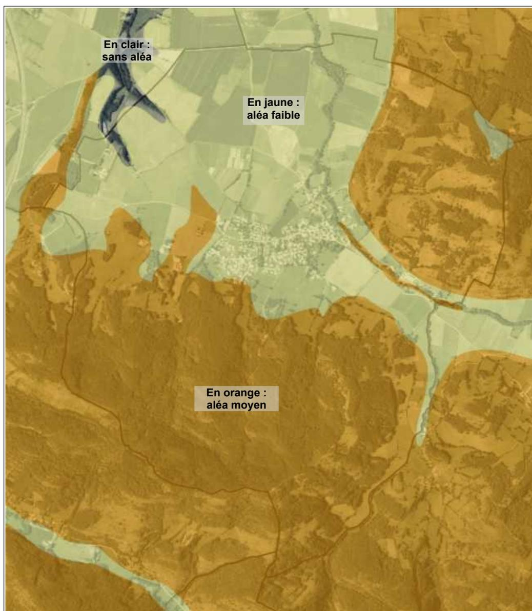
Figure III.18: zonage de l'aléa retrait / gonflement des argiles sur orthophotoplan établi par le BRGM (source [geotisque.gouv.fr](http://geotisque.gouv.fr)).
