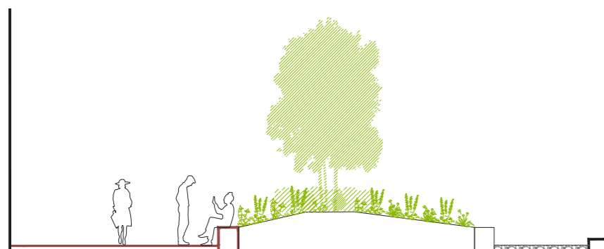
③ Coupe de principe sur massif haut : - épaisseur de substrat comprise entre 50cm et 100cm - assise périphérique bois - métal - plantation d'arbres en cépée, arbustes, vivaces et graminées
