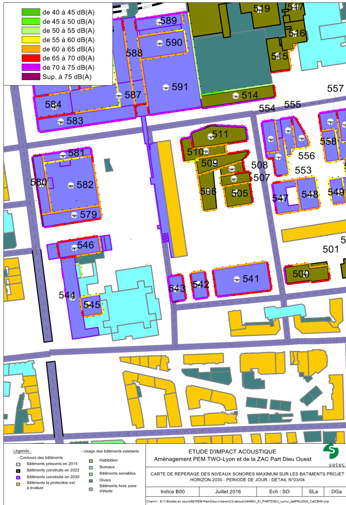
Niveaux sonores maximums en façades des bâtiments créés / JOUR, horizon 2030 / GARIBALDI, LAC
