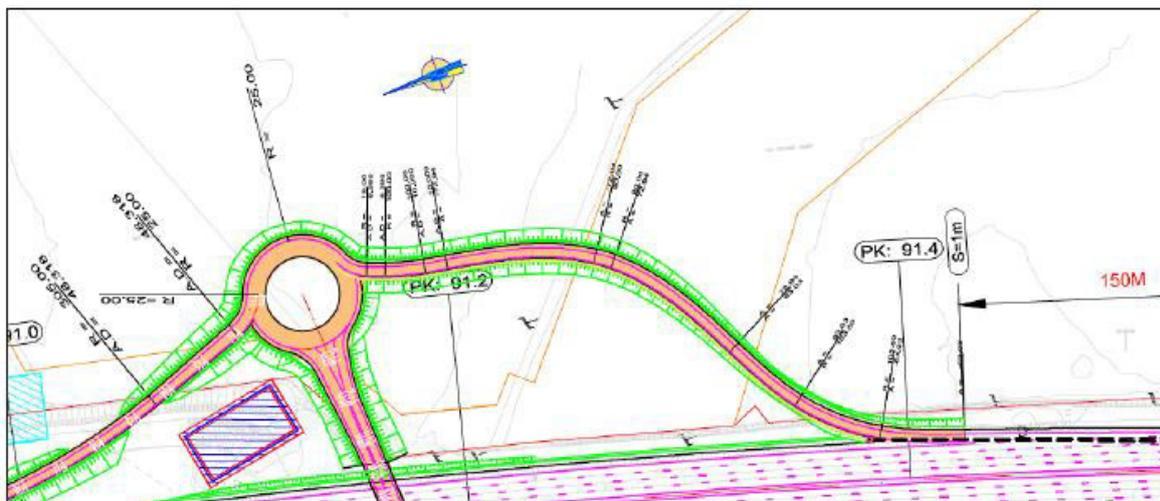
Figure 5 : Bretelle de sortie sens Orléans-Paris – giratoire conforme
