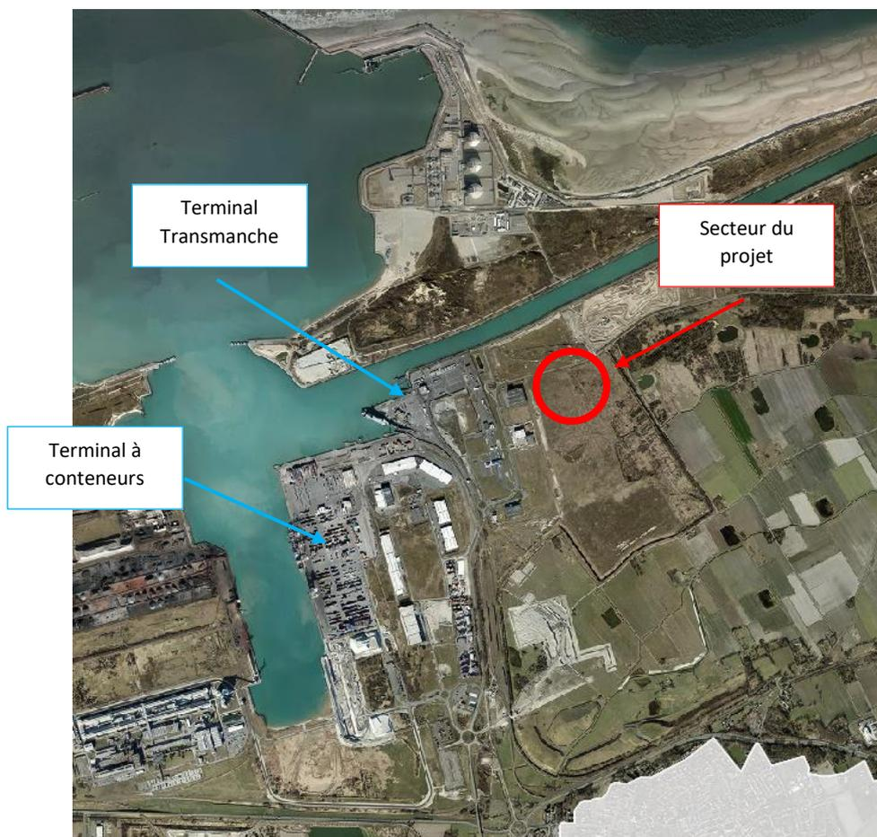
Le port ouest de Dunkerque a été aménagé à partir des années 1970 et a fait l'objet de remblais importants avec des sables de dragages provenant de l'aménagement progressif du port ouest. Le secteur DLI Nord a fait l'objet de remblais sur une hauteur comprise entre 2 et 3 mètres.
