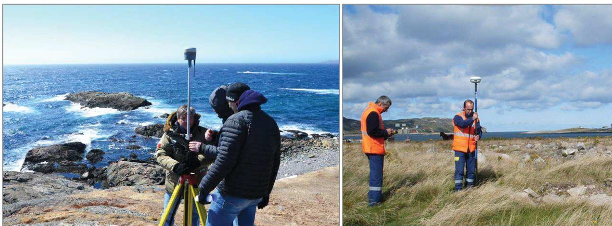
Illustration 14 - Equipes de la DTAM réalisant des mesures topographiques sur le terrain
