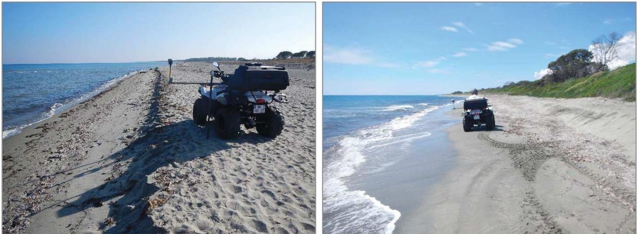
*Illustration 75 - Quad utilisé par le Réseau d'Observation du Littoral en Corse pour le levé du trait de côte dans la plaine côtière orientale (BRGM)*
