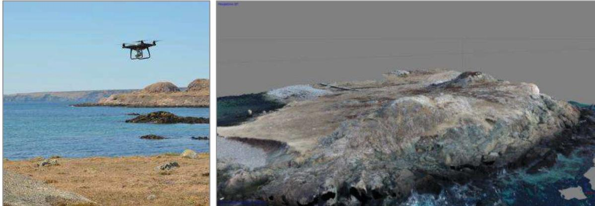
*Illustration 76 - Drone de la DTAM à gauche et modélisation de la pointe Diamant par photogrammétrie à droite (source DTAM)*
