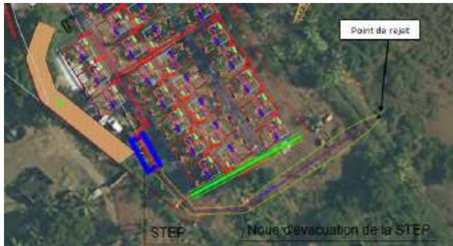
Figure 37 : Focus sur le point de rejet de la STEP en milieu naturel (Source : ETG 2020)
