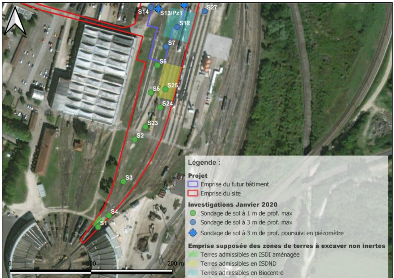
FIGURE 46 : REPRESENTATION CARTOGRAPHIQUE DES ZONES DE TERRES NON INERTES ENTRE 0 ET 1 M DE PROFONDEUR – SUD DU TECHNICENTRE (SOURCE DU FOND DE PLAN : GOOGLE MAPS )
