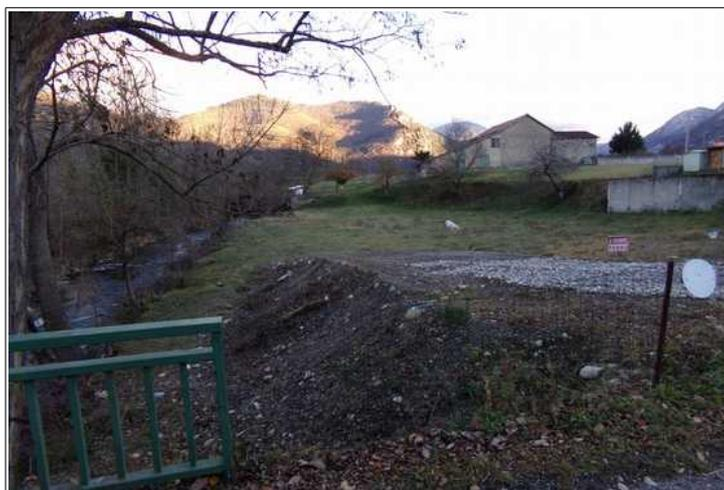
*Figure 3.18: terrain potentiellement inondable en rive droite à l'aval du chemin de Florac. Le talus souligne le lit majeur du cours d'eau.*
