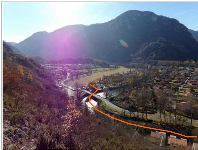
Figure 3.39: vue du pied de versant de Courtalet et de la zone d'arrêt probable des blocs (ligne orange).
