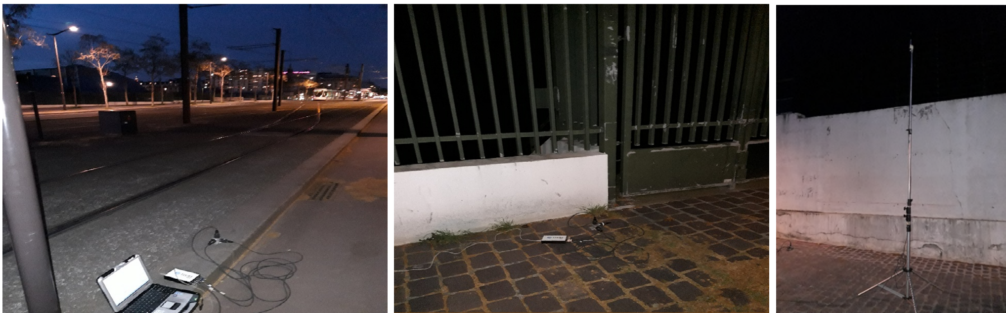
Figure 5 : Illustration du positionnement des accéléromètres et du microphone au droit du terminus Porte de Versailles.
