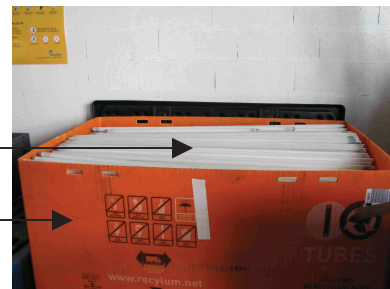
Photo 3 : stockage des tubes fluorescents à l'horizontale
