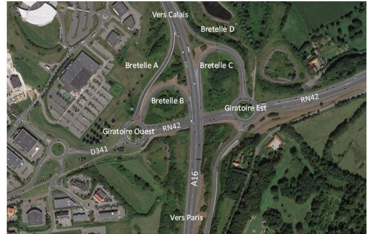
Figure 2 : Configuration actuelle du diffuseur n°31.
