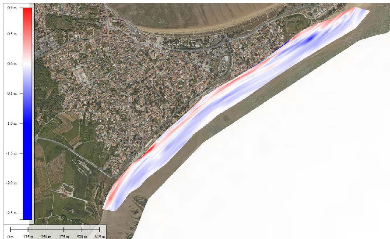
Figure 33 : Différentiel du niveau de plage entre 2016 et 2017 (réalisé à partir des données CASAGEC de 2016 et 2017).
