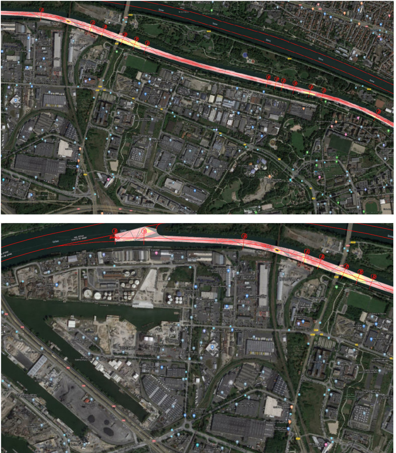
Figure 2. Zoom sur la Modélisation en cours du bras de Gennevilliers pour évaluer la quantité de sédiments à draguer (BIEF) de l'amont vers l'aval
