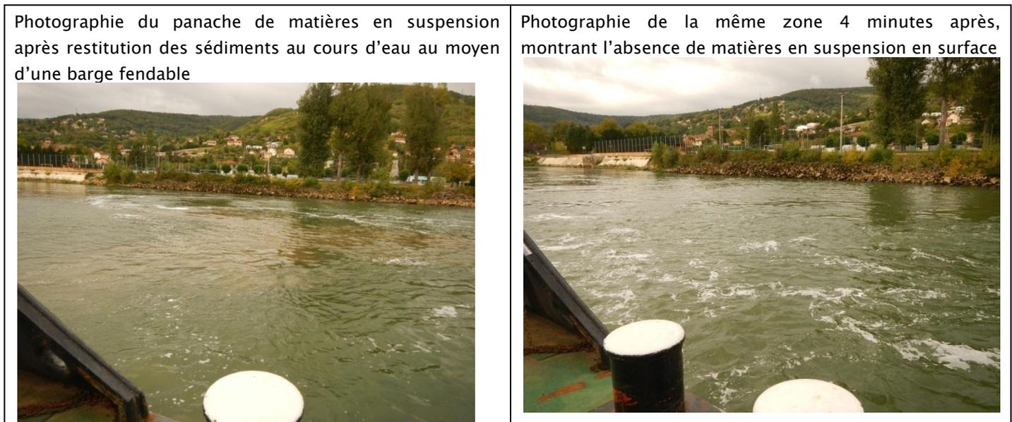
Figure 2 : Photographies illustrant la courte durée du panache turbide suite à une opération de restitution des sédiments dans la Saône au moyen d'une barge fendable
