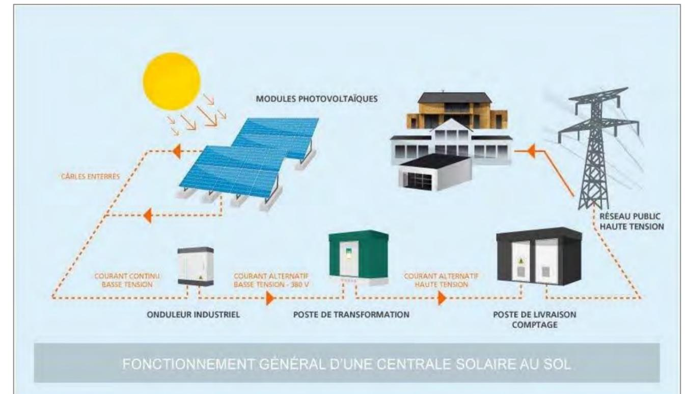
Figure 15 : Schéma de fonctionnement général d'une installation photovoltaïque
