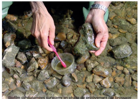
Biofilm de diatomées sur pierre en phase de prélèvement par brossage
