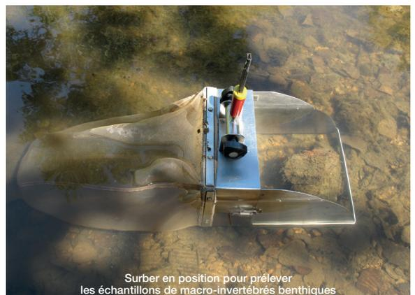
Surber en position pour prélever les échantillons de macro-invertébrés benthiques
