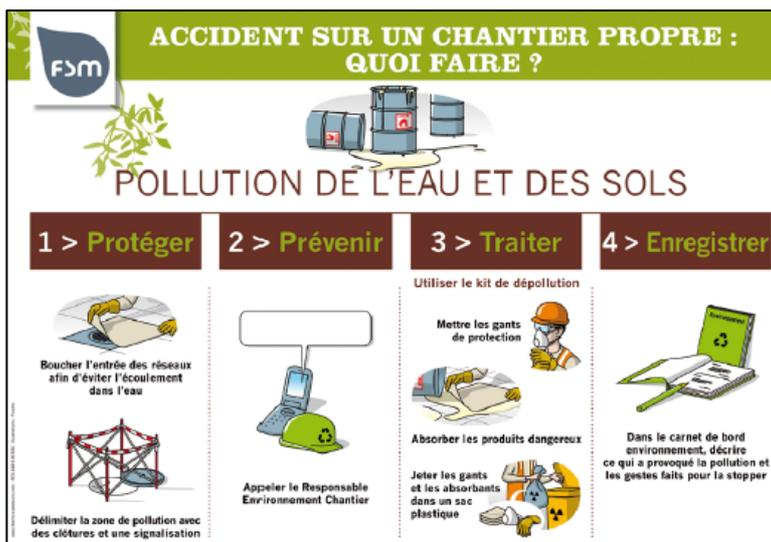
**Figure 57 : Procédure de prévention des pollutions accidentelles** (Source : Guide pratique – chantier & environnement FSM)
