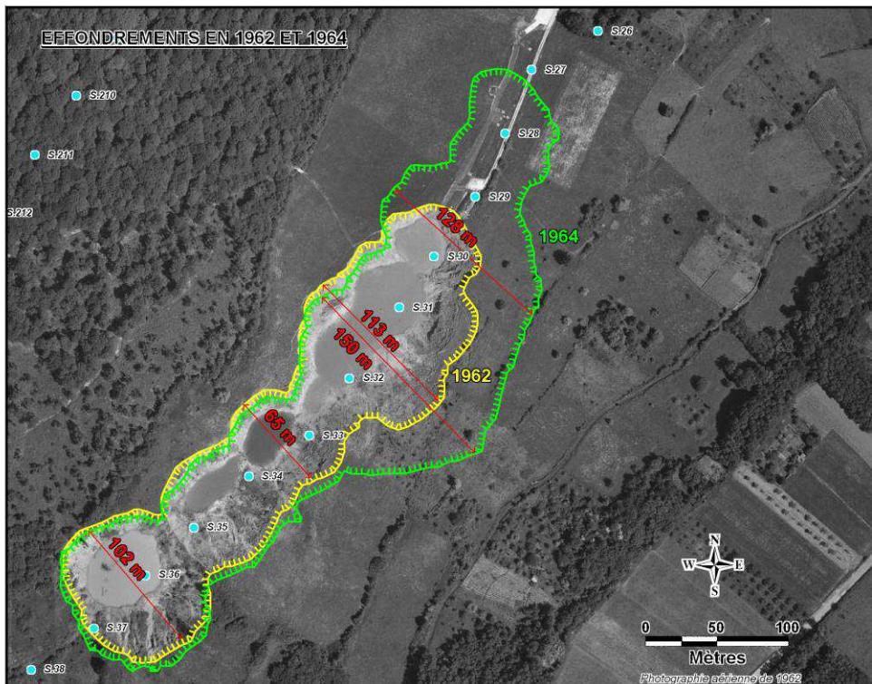
Figure 26 : Evolution des dimensions des cratères de l'amont de la piste 1 observées sur les photographies aériennes de 1962 et 1964
