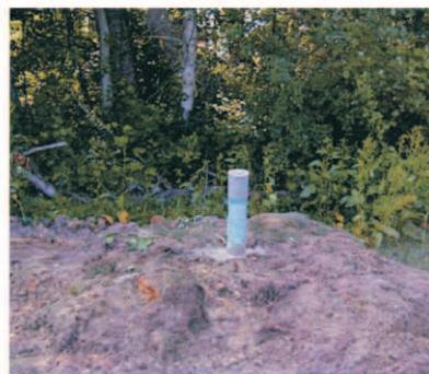
Un suivi piézométrique a été effectué de juin 2003 à juin 2004, la fréquence des mesures étant mensuelle. Le Tableau 14 récapitule les niveaux d'eau mesurés dans le piézomètre.
