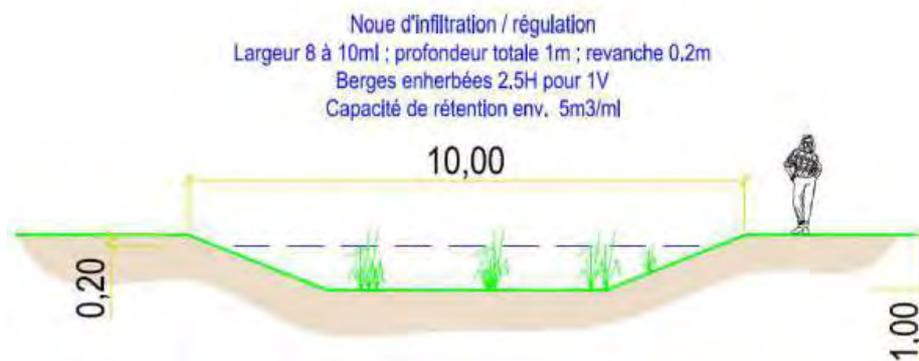
Figure 4 : Schéma de principe des noues
