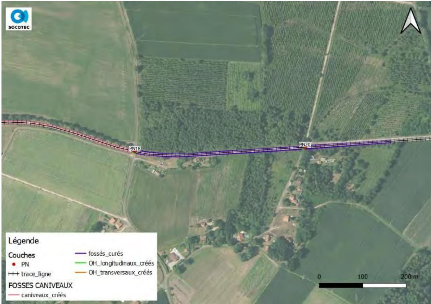
Figure 21 : Localisation des ouvrages hydrauliques (carte 10/13)
