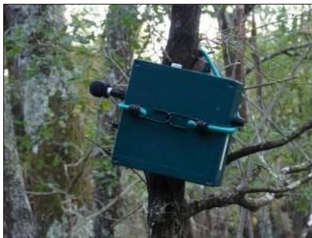
Station fixe d'enregistrement automatique des signaux de chiroptères avec système SMzBAT. Le dispositif est fixé sur un arbre.
