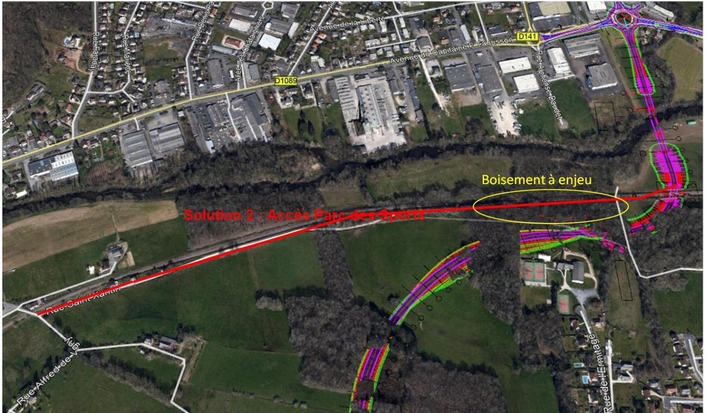
La solution 3 consiste à aménager un franchissement temporaire de la Corrèze grâce à une passerelle (ou estacade). Cette solution permet de limiter fortement l'impact sur les habitats et les espèces puisque l'accès reste dans la limite des emprises du projet, et n'implique donc aucune destruction d'habitat additionnelle ni aucun dérangement lié au passage des engins dans des milieux sensibles.
