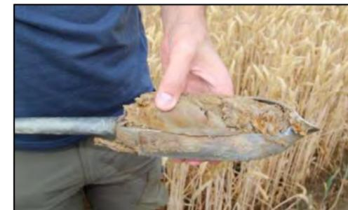
L'intégralité de la première carotte stockée dans la tête de la tarière est prélevée. Le prélèvement est déposé dans une gouttière en veillant à ne pas déstructurer la carotte.
