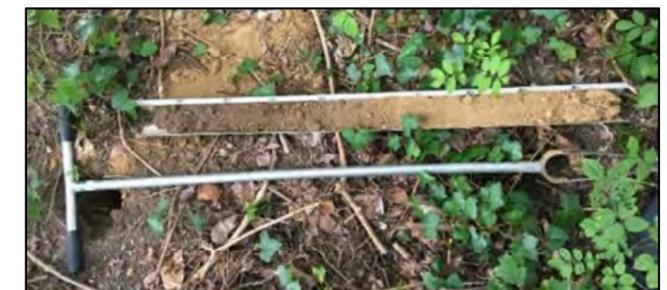
Les analyses pédologiques ont été réalisées durant l'hiver 2019-2020. Les points d'analyse pédologique seront géo-référencés à l'aide GPS Trimble Juno series. 152 sondages pédologiques ont été réalisés au niveau de l'aire d'étude.
