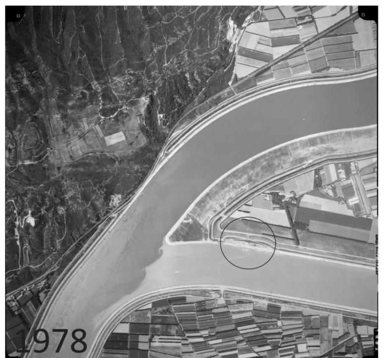
*En 1970, les travaux sont terminés, on voit le large remblais formant la digue du Rhône ainsi que le contre-canal et le Plan d'eau. Sur la photo de 1978, on voit un port de plaisance et ses bateaux. Une végétation pionnière commence à recouvrir la digue du Rhône.*
