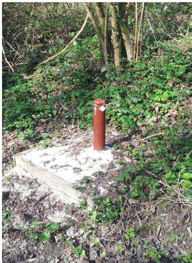
*Piezomètre Aval Remblais*
