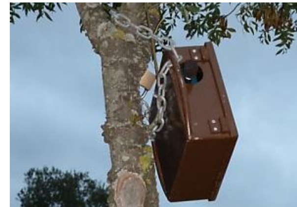
Dispositif d'enregistrement automatisé de type Wildlife Acoustics SM2 Bat Detector
