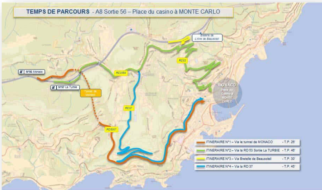
Figure 6 – mesure des temps de parcours selon les scénarios (simulation dynamique – étude mvaconsultancy)
