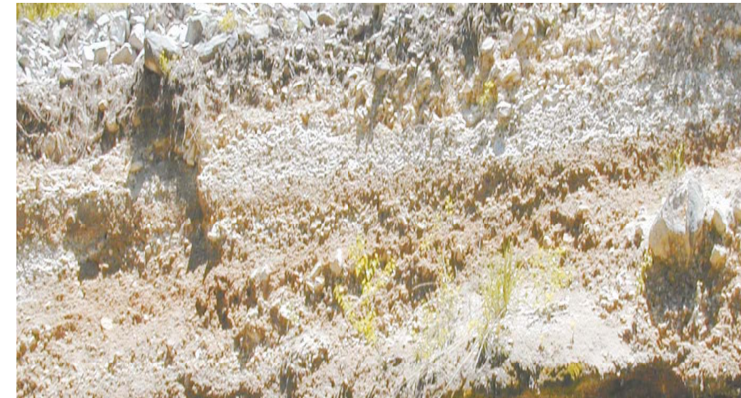
Figure n°39 C: faciès EL . Eboulis lité. Alternance de lit fin (marron) où domine la matrice et de lit plus grossier (clair) dominé par les débris rocheux. L'ensemble montre un bon classement granulométrique.
