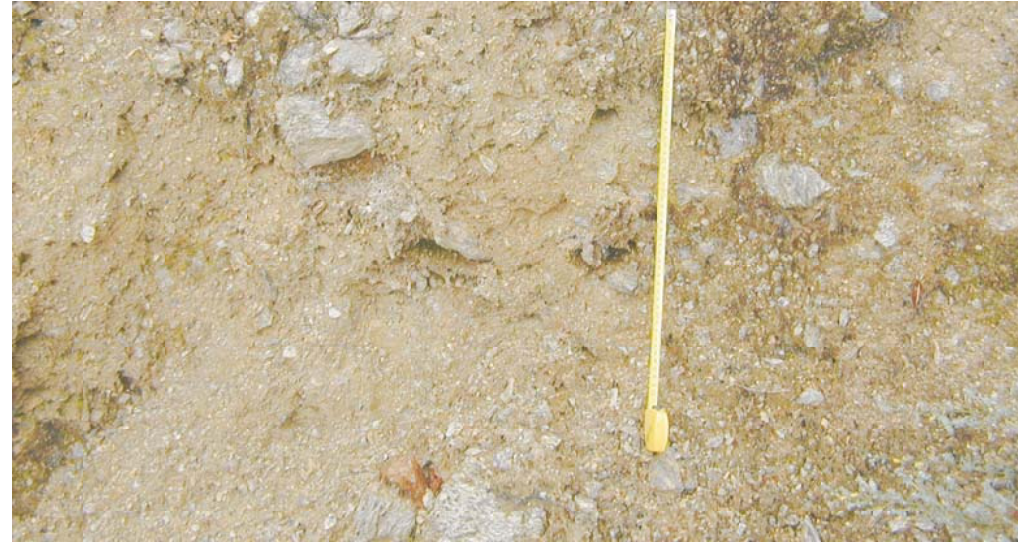
Figure n°39 A : faciès AMM . Prédominance de la matrice argilo-limoneuse et quasi-absence de contact entre les débris rocheux.
