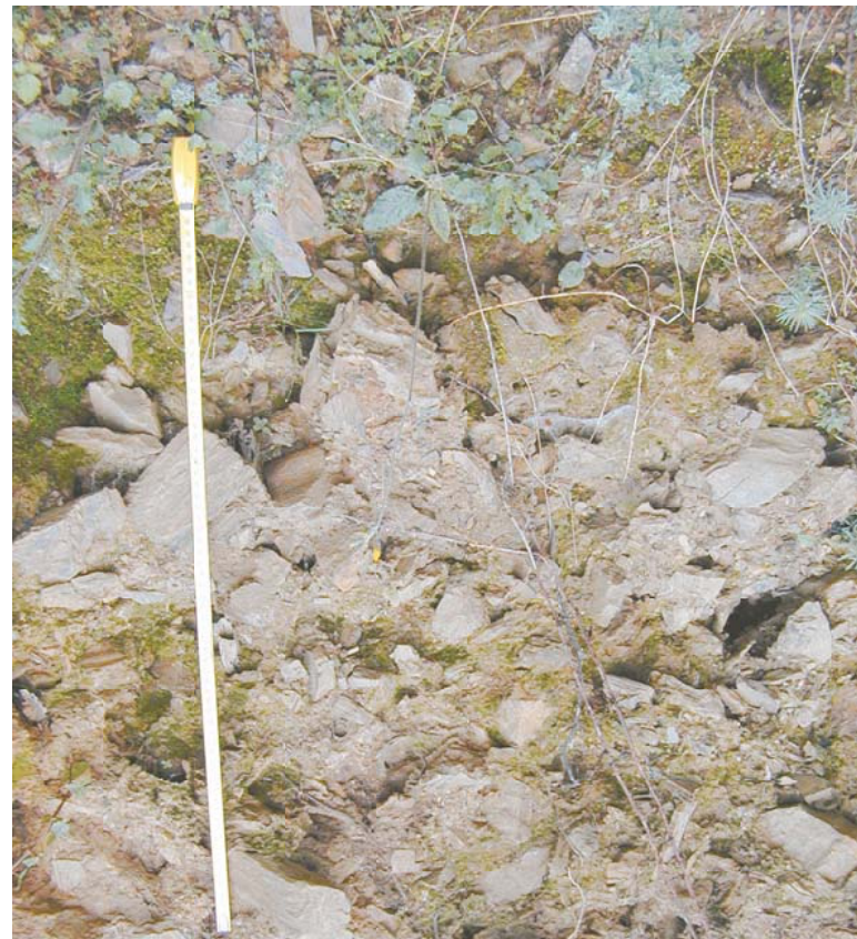
Figure n°39 B : faciès AMG . Prédominance des débris rocheux qui montrent de nombreux contacts ponctuels. Les contacts longs sont rares car la matrice jointe les éléments grossiers.
