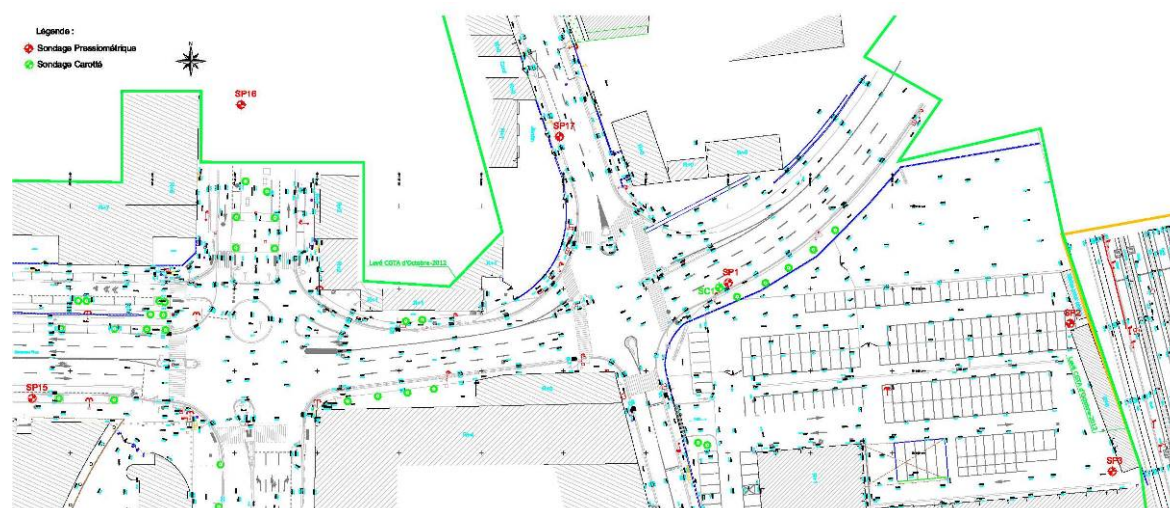
Localisation des sondages carottés et pressiométriques – Planche 2 – Ouest des voies ferrées (Source : Etude géotechnique préalable (G1), Plaine Commune-ABROTEC, 2016)
