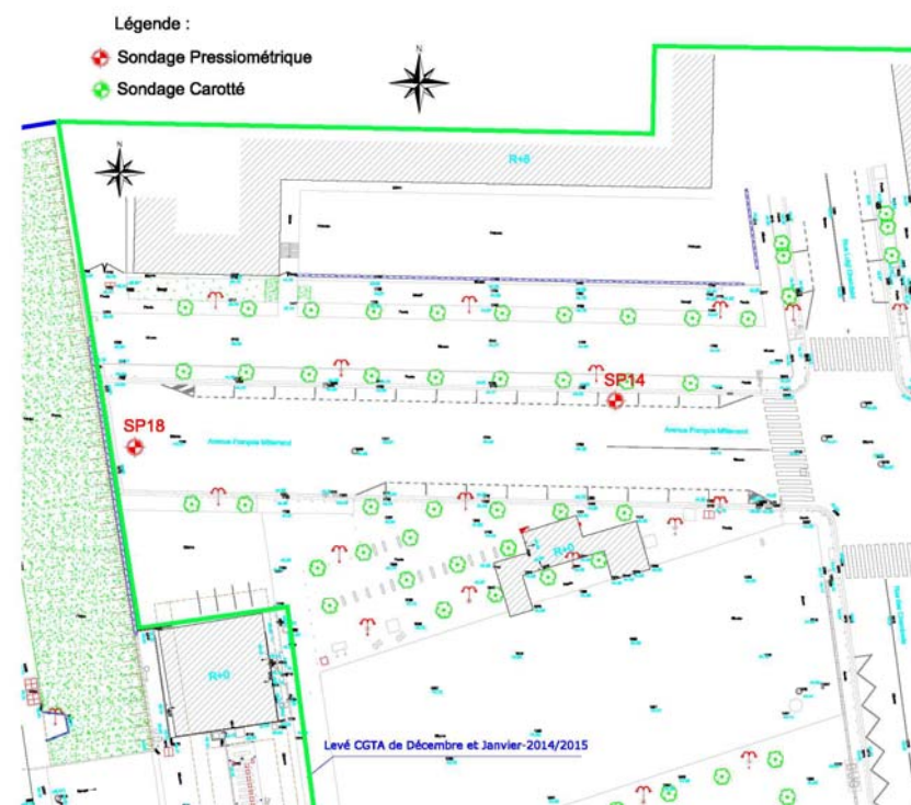
Localisation des sondages carottés et pressiométriques – Planche 1 – Est des voies ferrées (Source : Etude géotechnique préalable (G1), Plaine Commune-ABROTEC, 2016)
