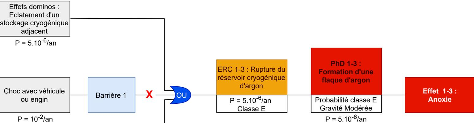
Barrière 1 : Rails de protection au niveau des zones à risque de collision
