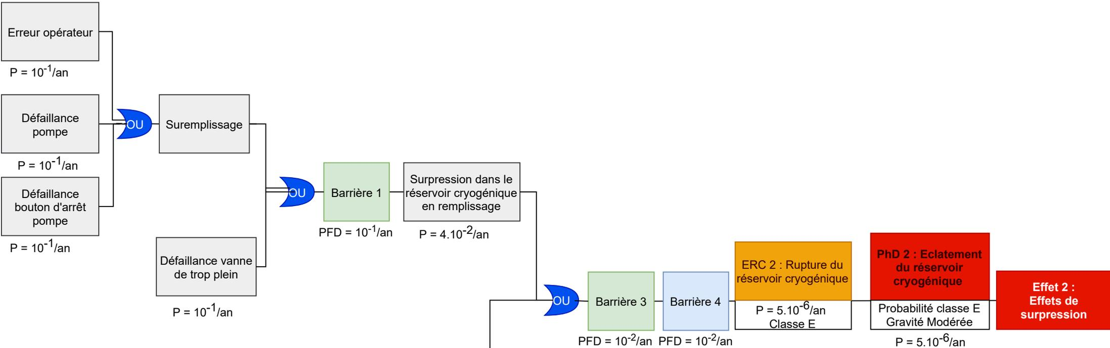
Barrière 1 : Détection de pression haute et fermeture de la vanne MG97
