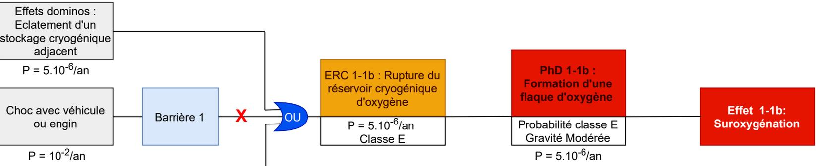
Barrière 1 : Rails de protection au niveau des zones à risque de collision
