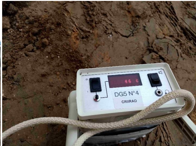
Illustrations 5 et 6 : Tas de terre secteur T3 et exemple de résultat de mesure (46 c/s)
