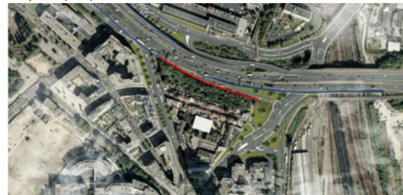
— Murs antibruit existants — Mur antibruit recréé
