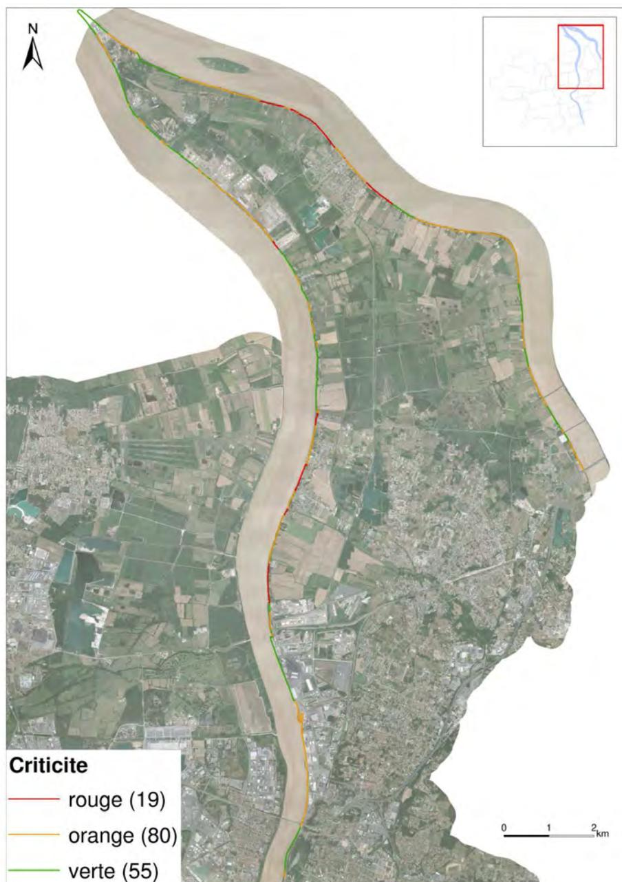
Figure 92 : Criticité des digues de la Presqu'île d'Ambès- Source : Etude de dangers des ouvrages de protection du SPIPA - 2015
