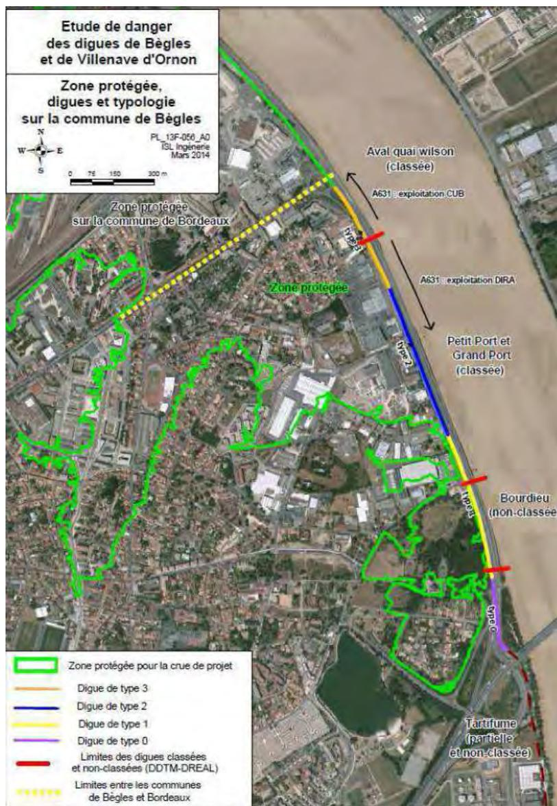
Figure 124 : Zone protégée par la digue de Wilson Bègles - Source : Bordeaux Métropole - Etude de dangers des digues de Bègles – 2014
