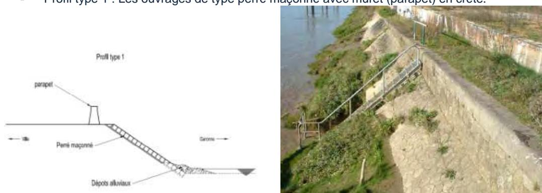
Figure 102 : Dignes de type perré maçonné avec muret en crête - Source : Etude de danger des ouvrages de protection du SPIRD – 2013
